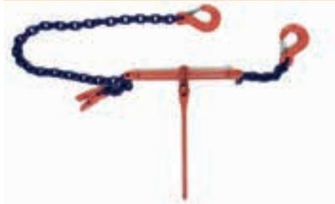
Kit di ancoraggio a 1 braccio, secondo EN 12195-3. Tenditore montato fisso. Grado 10. Con 2 ganci a forcella, 1 gancio accorciatore con sicura, tendicatena a cricchetto con dispositivo anti rotazione. Targhetta e certificato.
