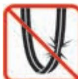
**Eliminare e sostituire le brache ad anello e le cinghie di sollevamento danneggiate.**
