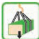
Controllare il peso del carico da sollevare. - **Non sovraccaricare!** Tenere conto del baricentro del carico.
